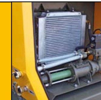
Bomba dosificadora de acelerador de fraguado Admixture dosing pump (shotcrete version)
