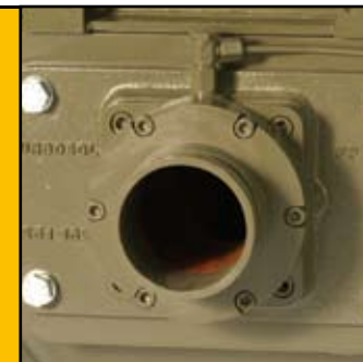
Colector de impulsión 4" 4" delivery manifold
