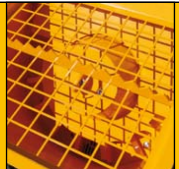
Interior de la tolva con dosificador de celdas inclinado Inside the hopper with inclined cell dosing
