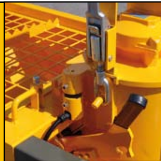
Dispositivo de seguridad electromagnético Electromagnetic safety device
