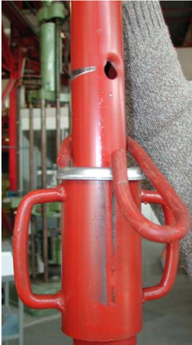
Foto 9, colapso por deformación de la perforación del tubo interno y deformación del gancho de apoyo.
