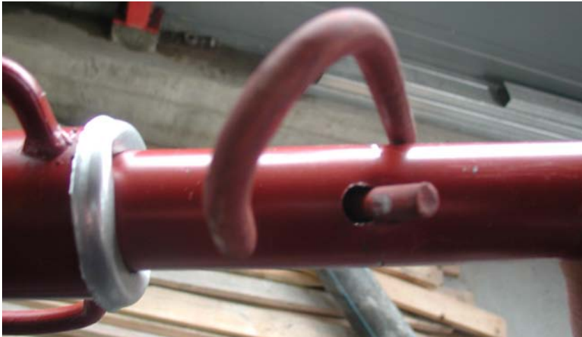
Foto 18, Colapso del gancho y deformación de la perforación.
