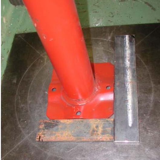
Foto 5, posicionamiento del apoyo inferior durante las pruebas con la prensa Amsler.
