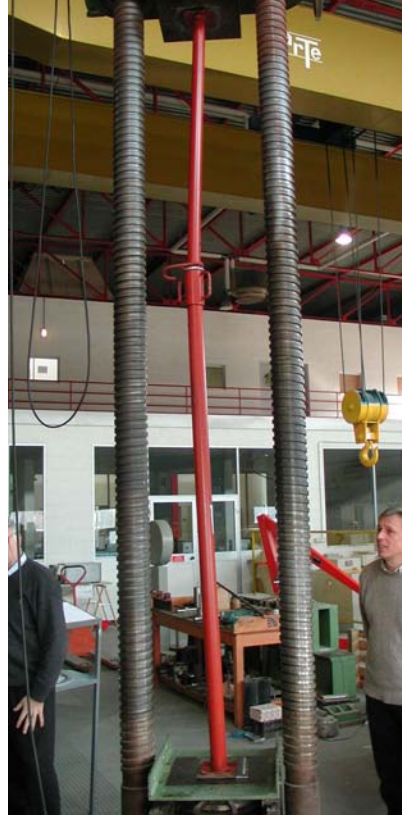
Foto 14, Inestabilidad del puntal.
