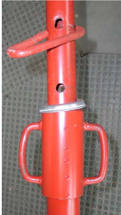
Foto 10, deformación y colapso del gancho.
