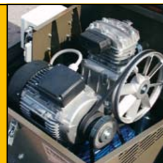
Compartimiento motor - compresor
