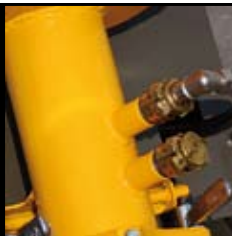
Cámara de mezclado
