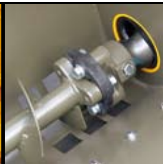
Interior de la tolva con agitador y acoplamiento elástico
