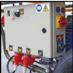
Cuadro eléctrico de mando de la bomba
