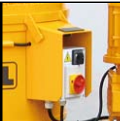
Cuadro eléctrico de mando del mezclador
