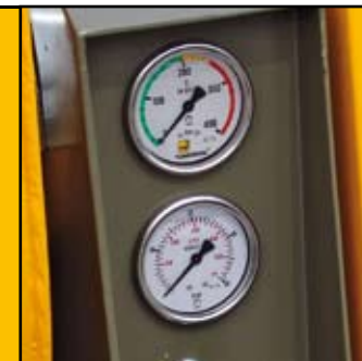
Manómetros de indicación de la presión del aceite del circuito hidráulico y variador de caudal Pressure gauges for the hydraulic oil circuit and delivery variation
