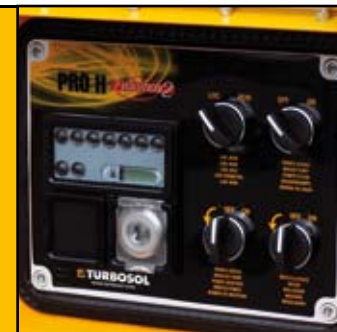
Cuadro electromecánico Electromechanical control board
