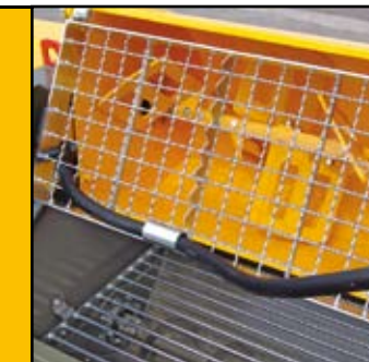
Mezcladora y tolva con rejilla de protección Mixer and hopper with protective grid
