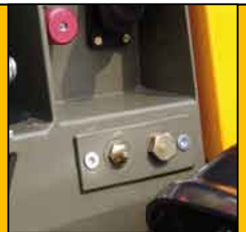
Punto de engrase del agitador de aspas
