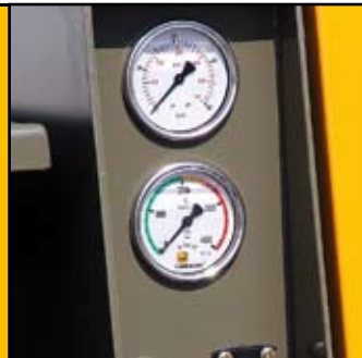
Manómetros de indicación de la presión del aceite del circuito hidráulico y variador de caudal
