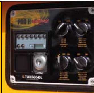
Cuadro de mandos electromecánico
