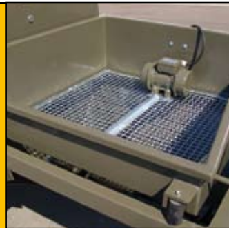
Criba con electrovibrador red abertura malla 20 mm
