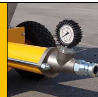
Unión manguera material y manómetro lectura presión de bombeo
