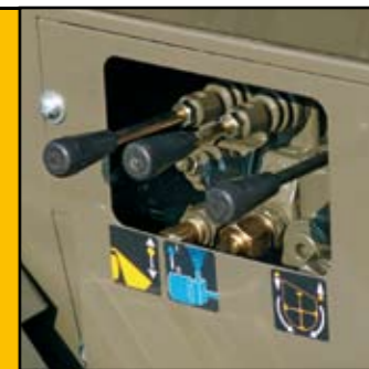
Distribuidor mandos circuito oleodinámico Hydraulic control circuit distributor
