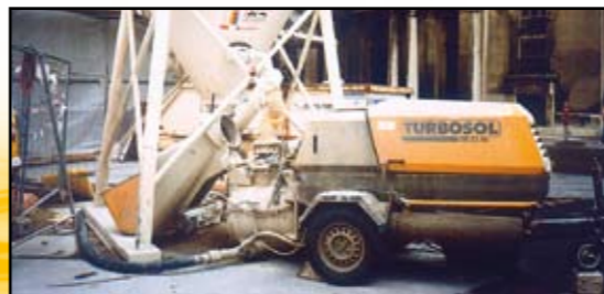
DC-SILO Para alimentación directa desde silo. Sólo bajo pedido. For silo feeding. Only upon request.
