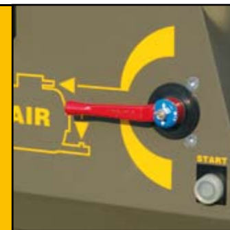
Válvula de aire y selector de inicio bombeo ciclo automático Air valve and automatic pumping cycle switch
