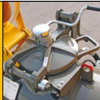
Dispositivos de seguridad en la abertura del depósito Safety device on the tank cover
