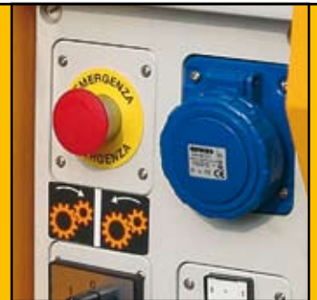
Botón seta para parada de emergencia y toma de corriente para la alimentación de las herramientas eléctricas Emergency push button and power socket
